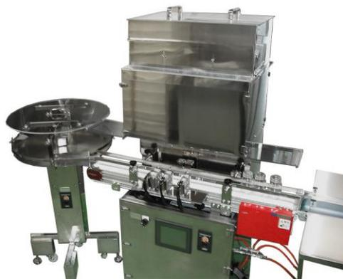
ボトルの自動搬送装置 (ターンテーブル・コンベア)
